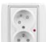
zásuvka dvojnásobná s natočenou vrchní dutinou, s clonkami, s ochranou před přepětím, s optickou signalizací poruchy
